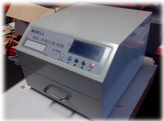
Figure 30 : Four à reflux
