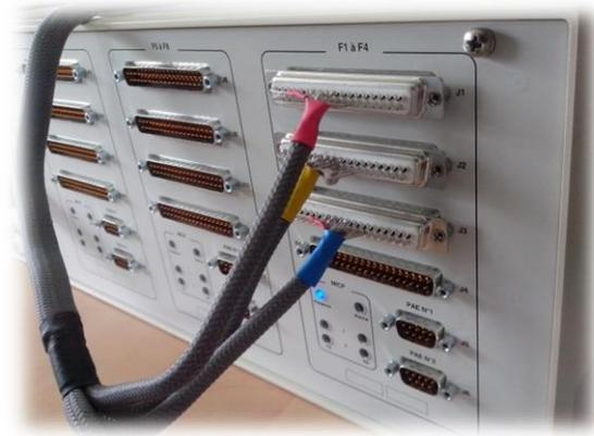
Figure 48 : Connecteurs arrière de la TCVL
